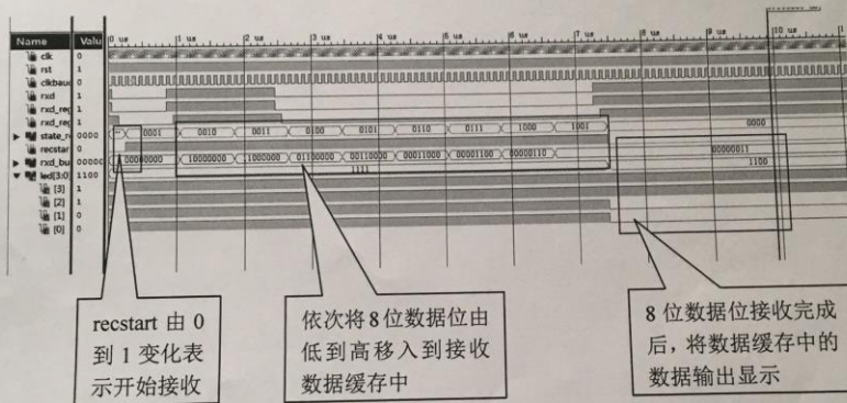
图 4 波特率可设置的串口通信控制模块仿真波形图
